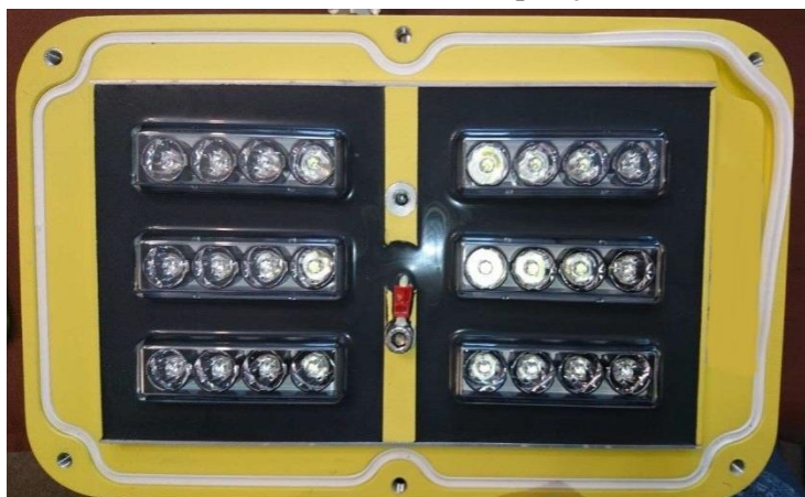
Figura 4. Projetor a LED sem o difusor, mostrando-se a disposição interna dos 24 LED.
