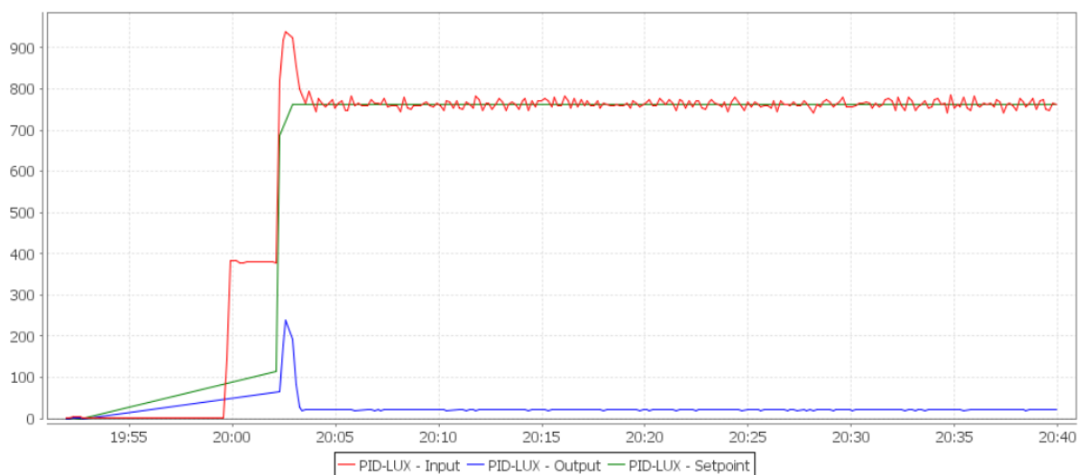
Figura 6. Detalhes da Resposta de controle, onde a luminosidade controlada (curva em vermelho) na planta seguiu a referência estabelecida (curva em verde).
