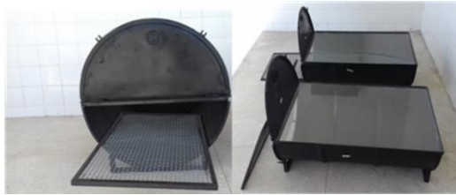
Figura 1. Versão 1.0 do secador solar de baixo custo
