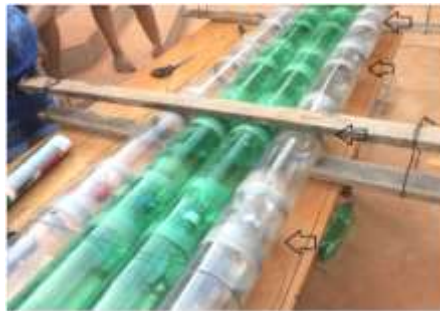
Figura 2: Setas indicam onde estão as emendas em uma longarina, que valem para as demais.
