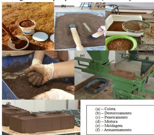
Figura 1. Etapas para fabricação dos tijolos.
