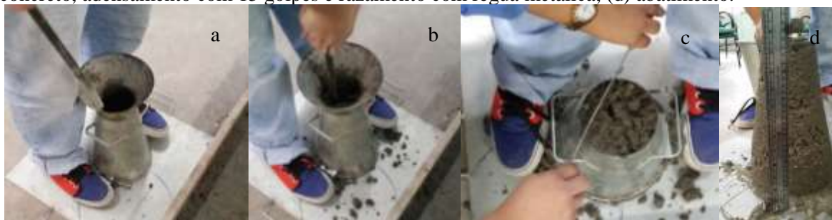
Figura 1. Ensaio de abatimento de tronco de cone. (a) primeira camada de concreto e adensamento com 15 golpes; (b) segunda camada de concreto e adensamento com 15 golpes; (c) terceira camada de concreto, adensamento com 15 golpes e razamento com régua metálica; (d) abatimento.
