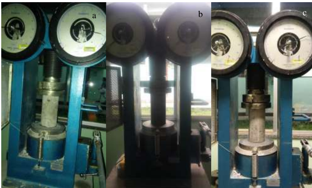
Figura 4. Rompimento dos corpos de prova. (a) corpo de prova rompido aos 3 dias; (b) corpo de prova rompido aos 7 dias; (c) corpo de prova rompido aos 28 dias;
