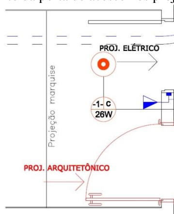
Figura 5. Diferença de posicionamento da porta de acesso nos projetos arquitetônico e elétrico.
