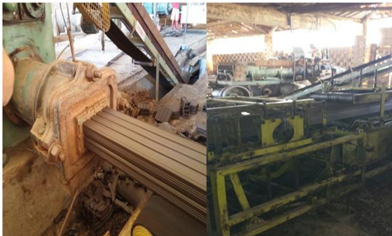
Figura 2. Processo de extrusão da cerâmica A e da cerâmica B
