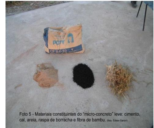
Foto 5 - Materiais constituintes do "micro-concreto" leve: cimento, cal, areia, raspa de borracha e fibra de bambu. (foto: Edson Sartori)
