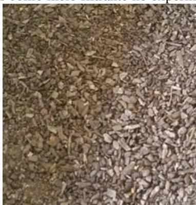
A granulometria foi escolhida com base em Piveli & Ferreira Filho (2015), e as dimensões e a composição dos meios filtrantes das colunas de filtração, podem ser observadas na Figura 2. As colunas foram fixadas em suporte universal, e para contenção dos meios filtrantes utilizou-se uma camada suporte de 3 cm de pedra brita, fechando a saída inferior do filtro com tecido não tecido (TNT).
