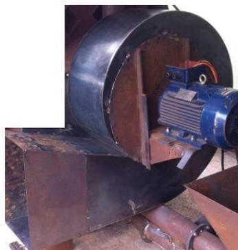
Para o cálculo da vazão, são realizadas medições da velocidade do escoamento na seção de saída. No total são medidos 12 uniformemente distribuídos, onde é possível calcular e comparar a vazão para cada ventilador. No ventilador original foi obtida uma vazão de 88 m<sup>3</sup>/min, já o ventilador
