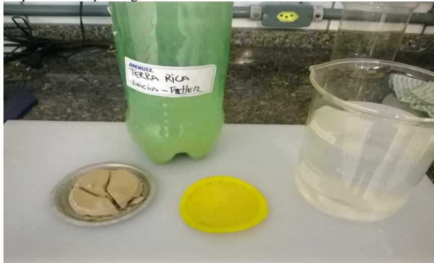
Figura 3. Material após teste de prensagem com 12% de umidade.
