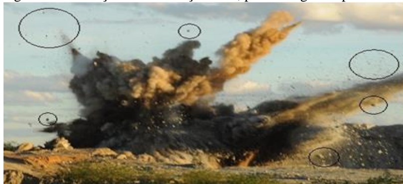
Figura 01 – Geração de ultralancamento, poeiras e gases após detonação.
