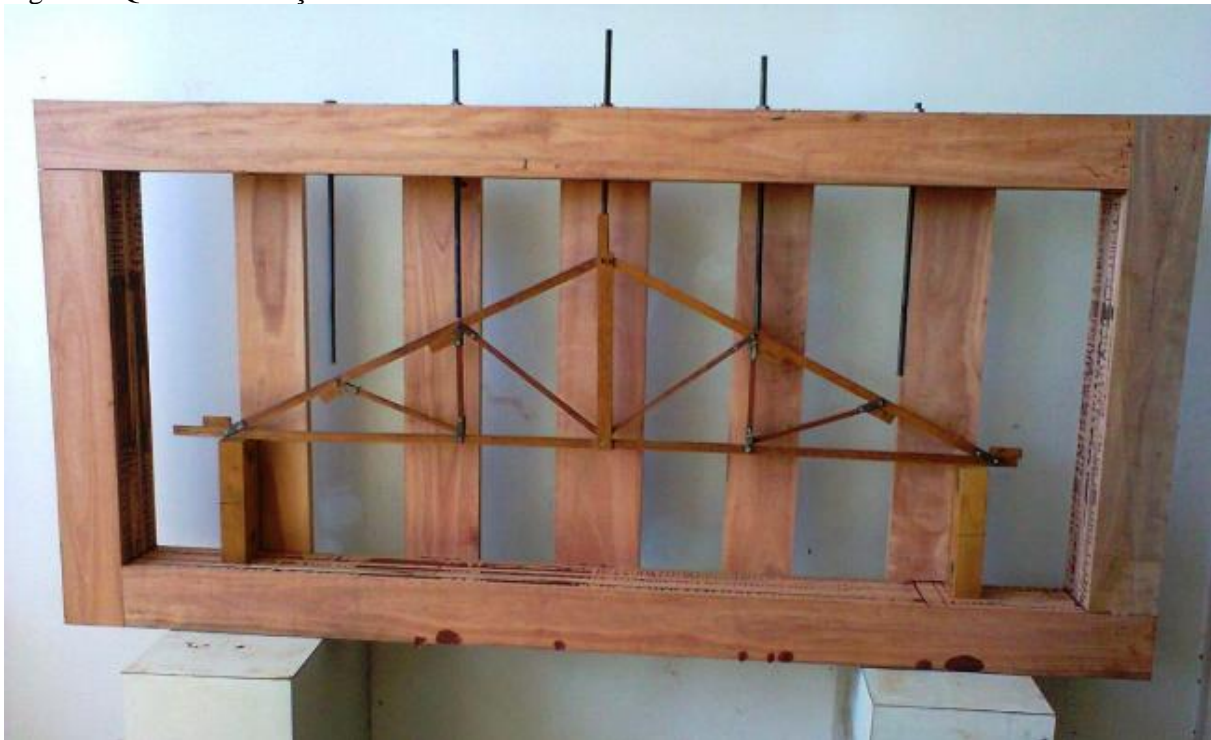
Figura 6. Quadro de Reação em Madeira Laminada Colada:
