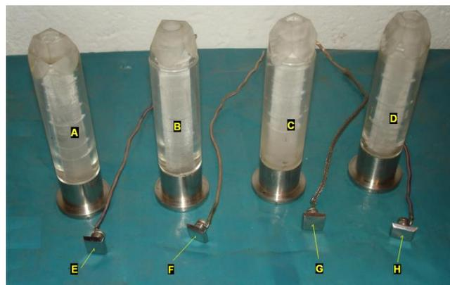
Sendo A, B, C, D: Pivôs móveis e E, F, G, H: Placas superiores dos sensores capacitivos.
