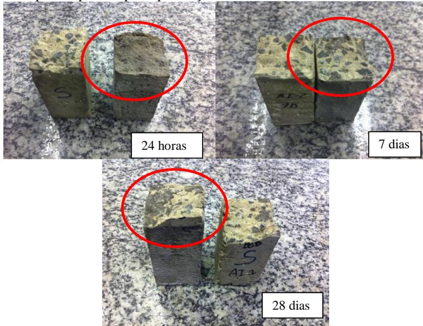
Figura 4. Evolução da resistência de aderência entre reparo e substrato pelo ensaio de tração na flexão.
