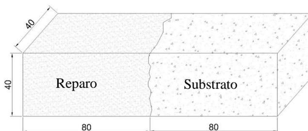
Foram analisadas três argamassas de reparo industrializadas específicas para reparos pontuais em estruturas de concreto armada comercializadas em Curitiba/PR cujas características estão apresentadas no quadro 1. O substrato de concreto genérico foi dosado com traço em massa de 1 : 2,17 : 2,94, com relação água/cimento de 0,60 e teor de argamassa de 51%, obtendo resistência característica de 25 MPa aos 28 dias. Na figura 2 observa-se o corpo de prova moldado e o substrato isolado.
