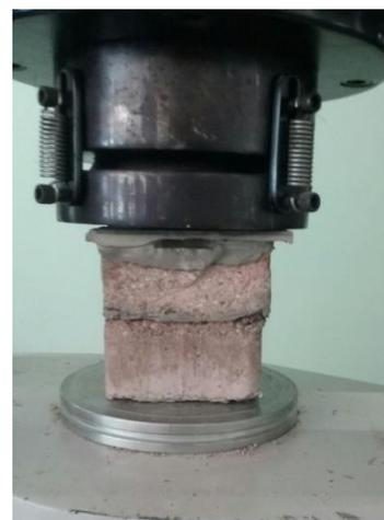
É possível perceber que a resistência média à compressão dos tijolos cujas dosagens eram solo + 60% de resíduo apresentaram resultados levemente menores que dos tijolos de dosagem solo + 40% nas duas datas de rompimento. Aos 28 dias, ambos superaram consideravelmente a resistência exigida pela norma, o que sugere que o resíduo é um ótimo estabilizador para o solo utilizado.
