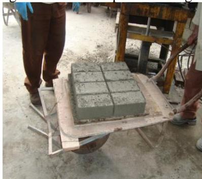
Para determinar a resistência característica à compressão de cada traço, foram seguidas as recomendações das normas ABNT NBR 9781:2013. Para a realização deste ensaio foram fabricados 18 pavers por traço, que foram rompidos aos 28 dias.
