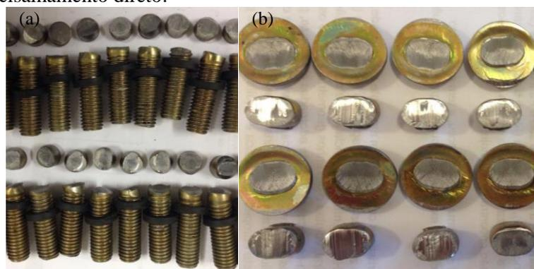
Com a simulação da ligação com a chapa metálica de silo determinou-se a carga real de ruptura do parafuso quando submetido ao contato com a chapa lateral utilizada pelos fabricantes de silo, com o intuito de averiguar possíveis divergências entre o cisalhamento direto do parafuso e o cisalhamento por contato com a
