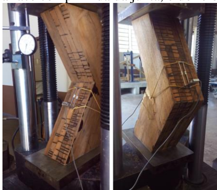
Figura 2 - Esquema geral de ensaio das juntas com destaque para os posicionamentos do extensômetro, na face comprimida da junta, e do relógio comparador.
