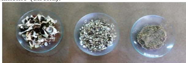
Figura 1. Material biossorvente antes do preparo (esquerda), após a primeira trituração (no meio) e após o processo de peneiramento (direita).
