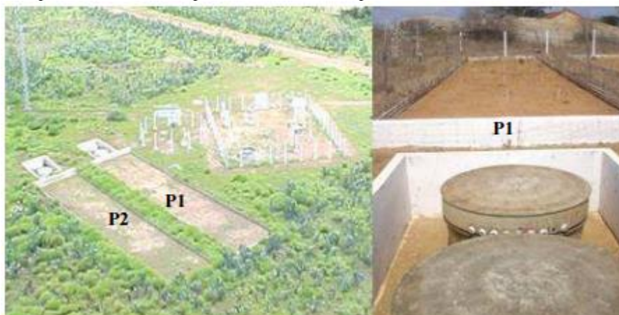
Figura 1. Área experimental com as parcelas de erosão tipo Wischmeier.
