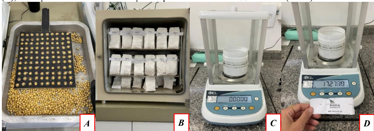
Figura 4 – Avaliação peso de mil grãos em laboratório. Tabuleiro com 100 sementes para separação de amostra (A); Amostras armazenadas em saco de papel em estufa de secagem com circulação forçada (B); Balança analítica zerada e balança com peso de amostra de 100 sementes (C e D).
