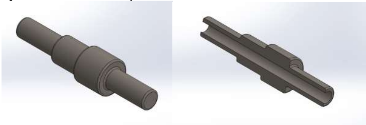
Figura 1 – Modelo 3D do eixo maciço e eixo vazado em corte
