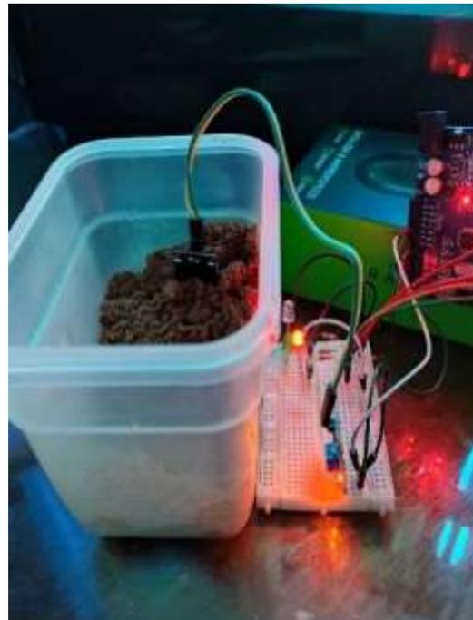
O estudo iniciou voltado para o desenvolvimento da programação do algoritmo, através disto se tornou possível integrar o sensor com o Arduino. Durante esta etapa se fez necessário a determinação de uma função que associasse o valor analógico obtido pelo sensor com a umidade do agregado.
