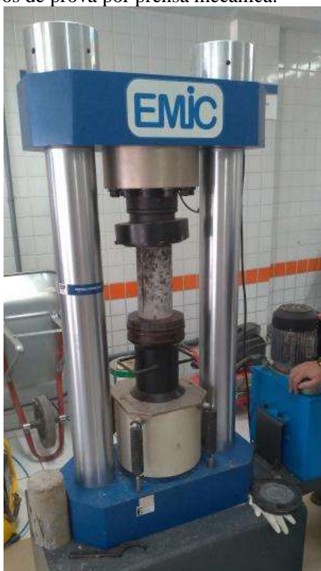
Figura 3. Rompimento dos corpos de prova por prensa mecânica.
