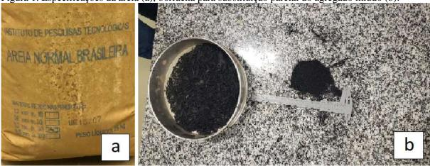
No total foram confeccionados 12 corpos de prova (CPs), sendo 3 com o concreto feito com o traço referencial, 3 com substituição de 4% do agregado miúdo pela borracha triturada, 3 com substituição de 8% do agregado miúdo pela borracha triturada e por fim 3 com substituição de 12 % do agregado miúdo pela borracha triturada. Os CPs foram desenformados após 24 horas e destinados a cura por submersão até a idade de 28 dias sendo sequencialmente submetidos ao ensaio de resistência à compressão.
