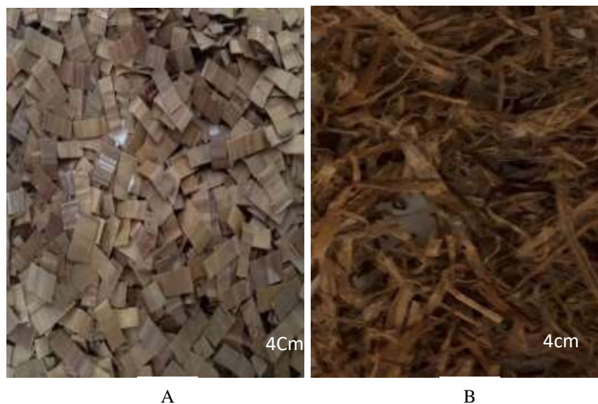
Figura 4: Fibras secas modificadas com o tratamento de NaOH: (A) Fibras in natura de 4 cm; (B) Fibras tratadas com NaOH DE 4cm
