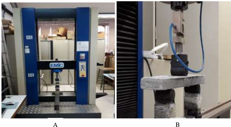
Figura 3: Ensaio de flexão dos materiais A) Dispositivo de ensaio à flexão; B) Compósito no dispositivo de ensaio à flexão.
