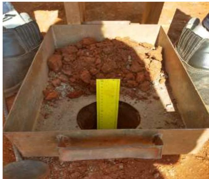
Figura 2 – Medição de profundidade do furo.
