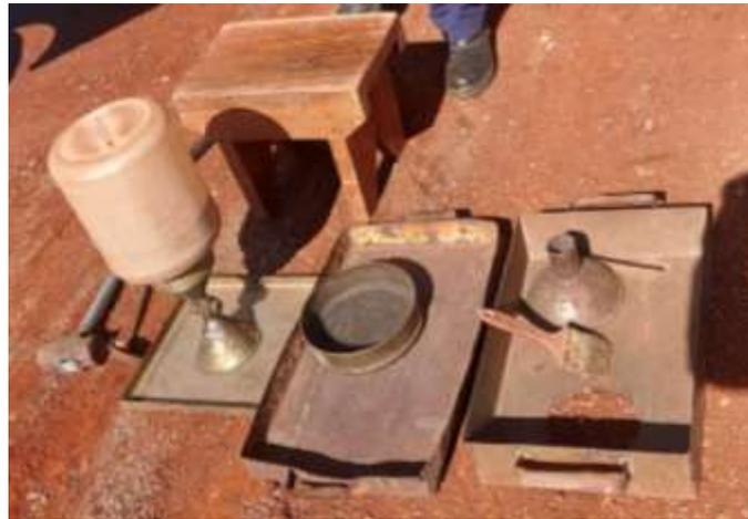
Figura 1 – Materiais para o ensaio de densidade in situ.
