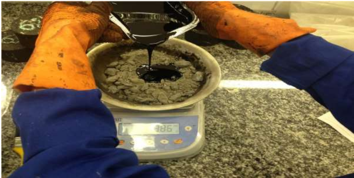
Figura 1. Ligante tipo asfalto-borracha sendo misturado ao agregado.
