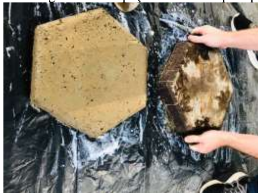
Figura 2. Desmoldagem de uma peça de concreto para pavimentação
