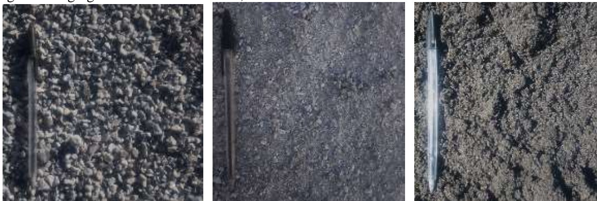
Figura 1. Agregados utilizados Pedrisco, Pó de Brita e Areia Artificial
